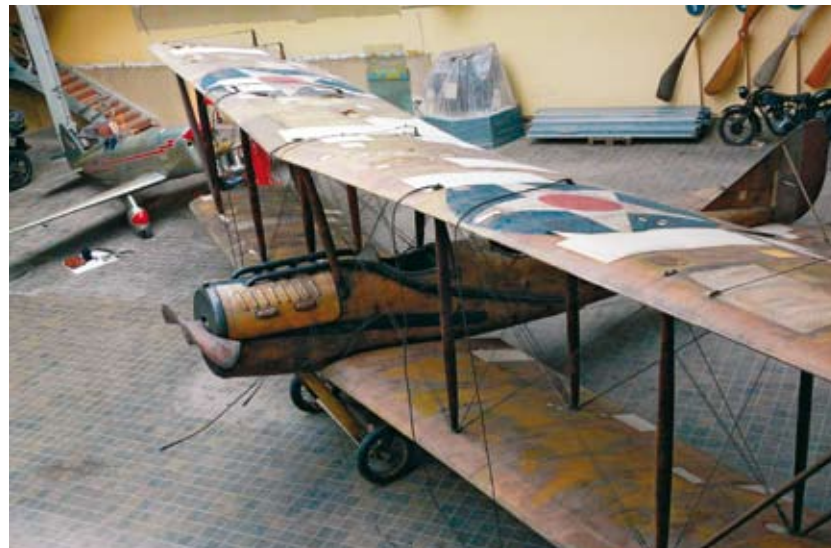
Po svěšení letounu Tractor se objevily na křídlech letadla jak staré záplaty, tak i nově poškozená místa
