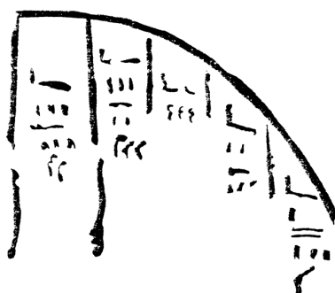
(29) Souřadnicové vyjádření oblouku; naznačeny vzdálenosti svislic a jejich výšky
